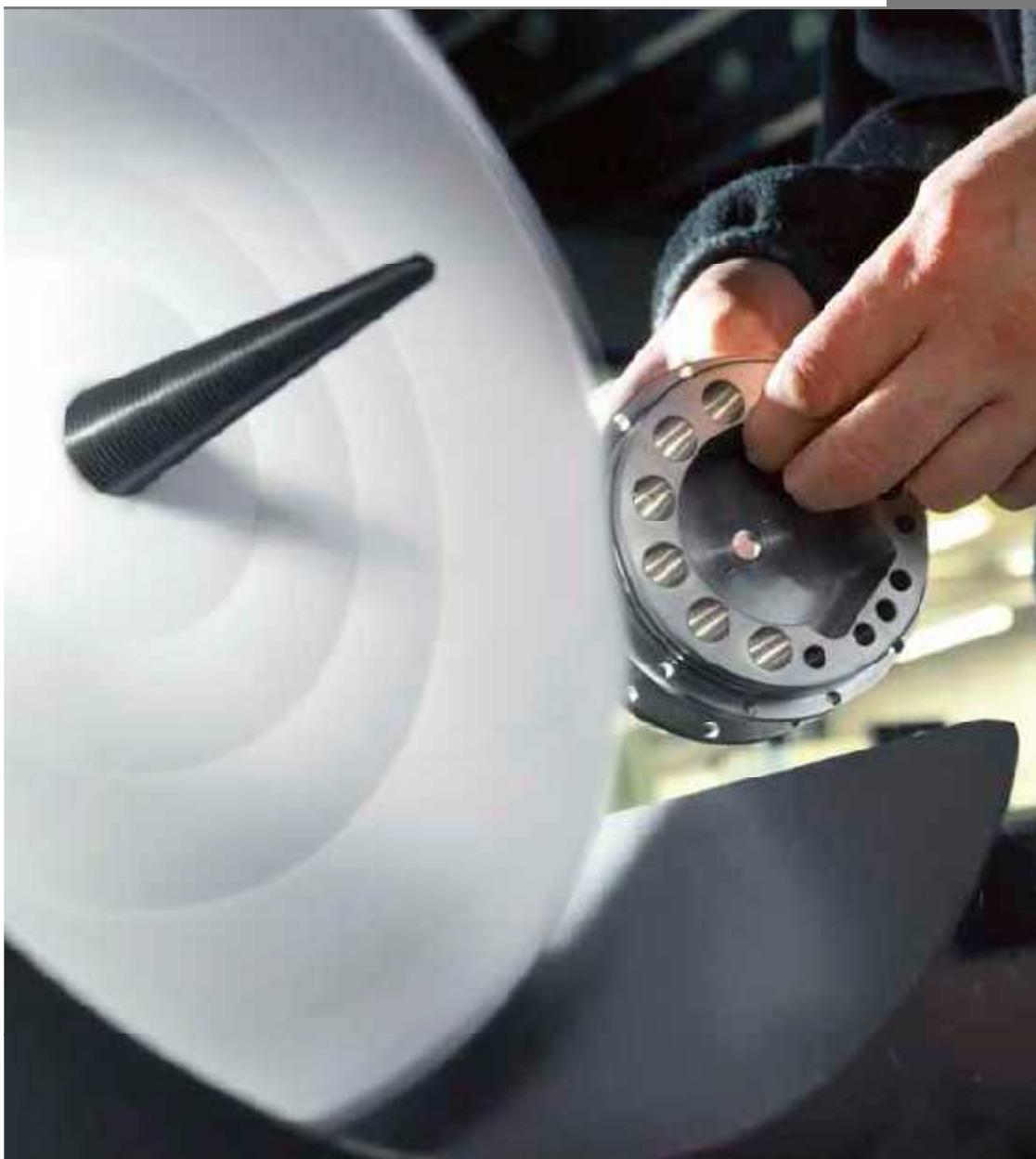
Nabízíme dva modely leštících strojů: dvoukotoučové leštičky (DP) ukončené hřidelemi a opatřené přírubami, vymezovacím kroužkem a matkou; a kónické dvoukotoučové leštičky (DPC) opatřené standardně kónickými leštícími vřeteny na konci hřídele. Oba stroje jsou k dispozici ve dvou modelech: pro leštící kotouče s průměrem 200 a 300 mm.
