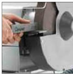
Orovnávací kámen pro zdrsnění, opravu a čištění brusného kotouče.
