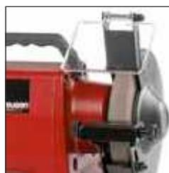
Nastavitelné podpěry obrobku s frézovanými matkami, které lze upravit bez použití jakýchkoliv nástrojů
