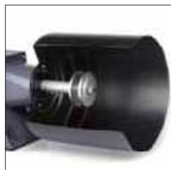
Kombinace brusného pásu a kotouče (BSS) umožňuje kombinovat broušení povrchů i kontaktní broušení na páse s konvenčním broušením pomocí brusného kotouče.
