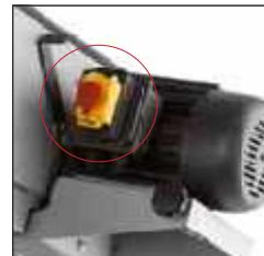
Vypínač s podpěťovou spouští a nouzovým přerušením napájení
